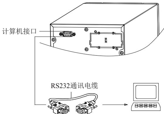
计算机接口：通过通讯电缆(用户配备的标准直通线,脚位一一对应的RS232串口线)连接UPS与监控设备。可使用山特图形化的WinPower监控软件(可从山特网站免费下载)。
